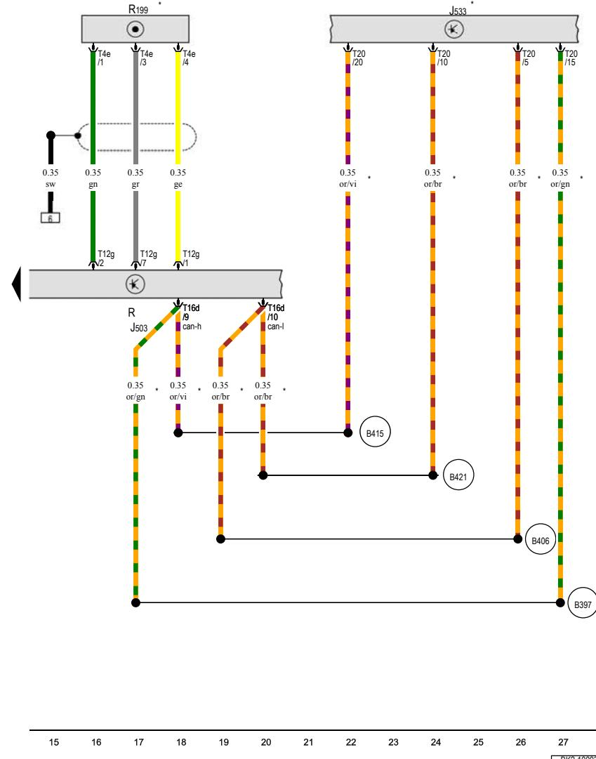
收音机及导航系统带显示单元的控制单元, 收音机, 外部音频源接口
