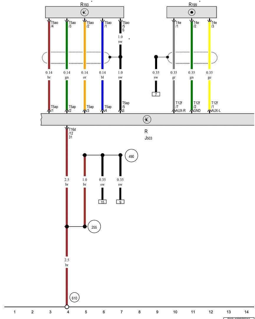
收音机及导航系统带显示单元的控制单元, 收音机, USB 接口支架, 外部音频源接口
